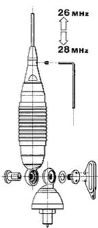
Точная настройка антенны на рабочую частоту производится перемещением штыря в фиксаторе. Для этого ослабьте фиксирующий болт при помощи шестигранного ключа, входящего в комплект поставки, установите штырь в требуемое положение и надежно зафиксируйте его.
