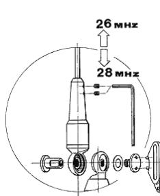
Точная настройка антенны на рабочую частоту производится перемещением штыря в фиксаторе. Для этого ослабьте фиксирующий болт при помощи шестигранного ключа, входящего в комплект поставки, установите штырь в требуемое положение и надежно зафиксируйте его.
